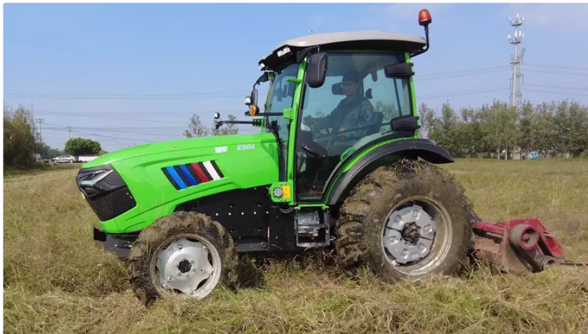
Der Cybertractor E904i verfügt über eine 105-kWh Batterie. (Bildquelle: ZSHX Advanced Tractors)
