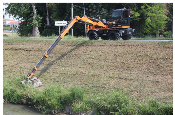
Der ILF Athena verfügt über eine Reichweite von 15 Metern. — Copyright: Energreen
