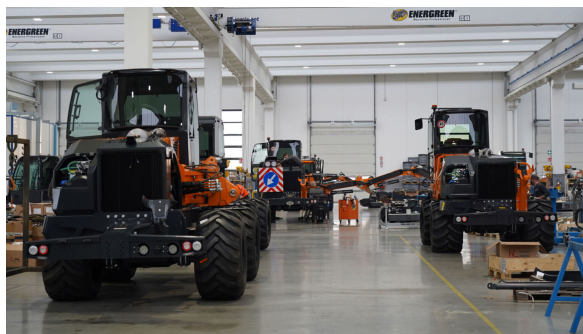
Endmontage der ILF-Selbstfahrer im italienischen Werk. — Copyright: Energreen
